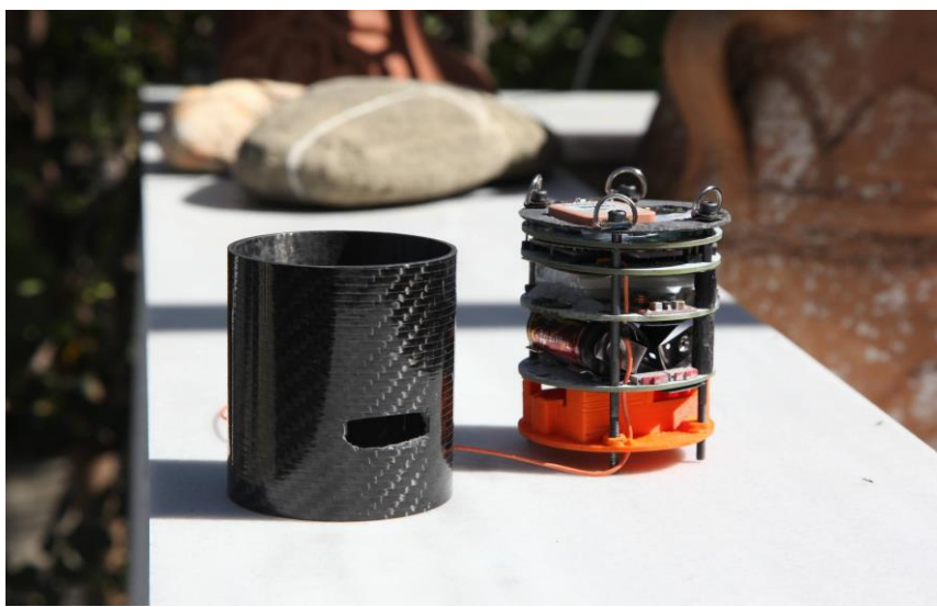
Εικόνα 3: Το θυγατρικό CanSat και το περίβλημά του.
