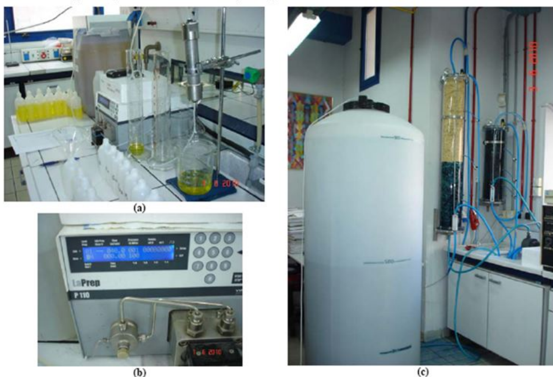
Εικόνα 2. (α) Εργαστηριακής κλίμακας στήλη ύψους 15 εκατοστών με δεξαμενή 25 L, (β) τη αντλία εργαστηριακής κλίμακας, και (c) πιλοτικής κλίμακας στήλη ύψους 137 εκατοστών με δεξαμενή 1000 L.
